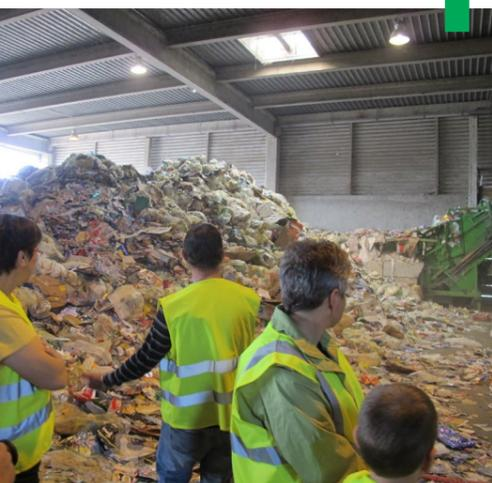
LE CENTRE DE TRI EST ÉQUIPÉ DE LIGNES AUTOMATISÉES. CHAQUE FLUX DE DÉCHETS EST DÉVERSÉ À L'ENTRÉE DE CHACUNE DES LIGNES, AFIN D'ALIMENTER DES TAPIS ROULANTS.
