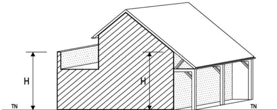
**Hauteur maximale :** différence d'altitude maximale admise entre tout point de l'édifice et sa projection verticale sur le sol naturel avant travaux.
