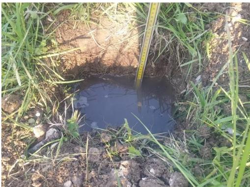
Sondage Ex9 en cours de test d'infiltration
