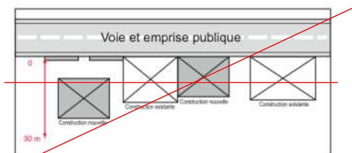
Exemple d'implantation dans le cas d'implantation d'une construction à côté de constructions existantes à l'alignement
