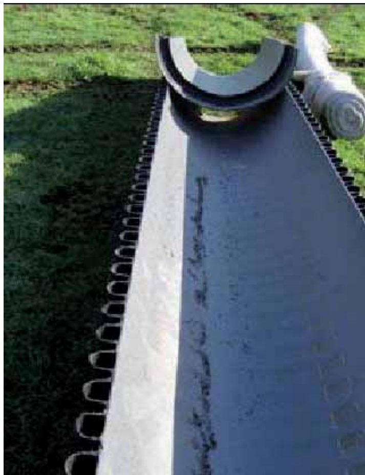
Tuyau PEHD coupé en deux dans le sens de la longueur
