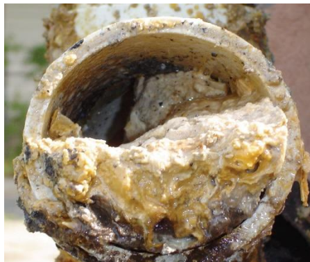
(Exemple de canalisation obstruée par de la graisse, source : lemonde.fr)
